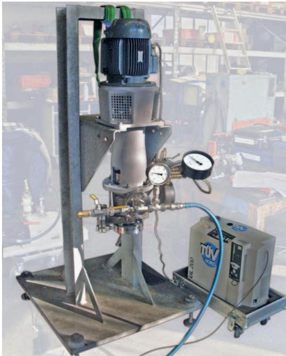
**Bild 3:** Dichtheitsprüfung mit dem Heliumtest
